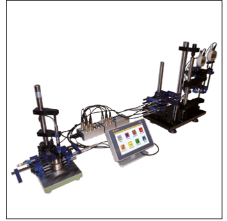
Conexión de palpador e indicadores por entrada M-Bus
