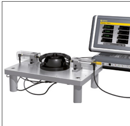
Sistema multicota conectado a interface D200S y display D300S
