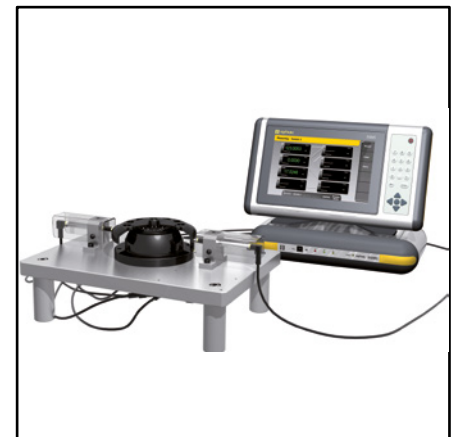
Palpador capacitivo en una plantilla
