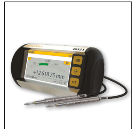
Palpadores P12D M8 conectados a un monitor D62S
