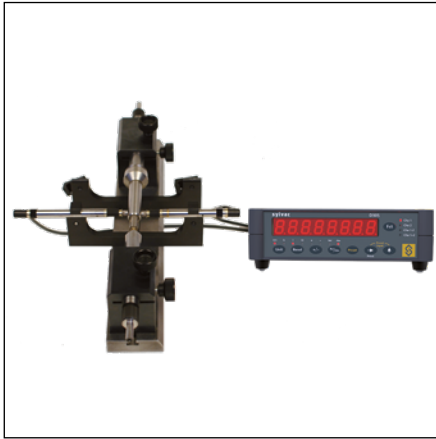
Midiendo un eje con 2 palpadores (A+B)
