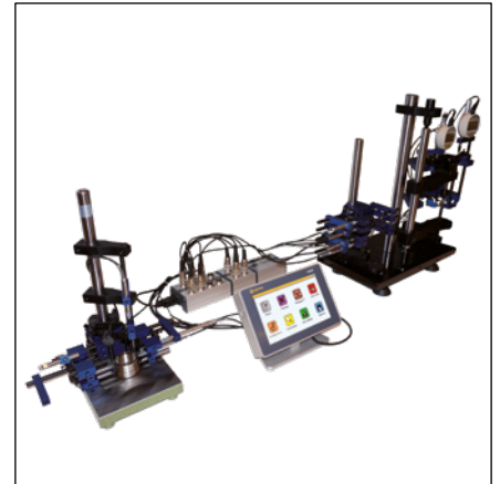
Conectando palpadores e indicadores por entradas M-Bus
