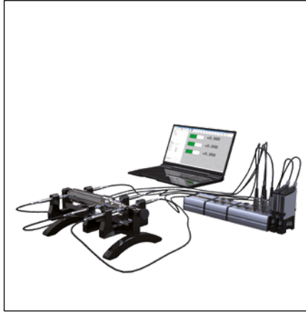
Conexión de palpador PC por MB-RS
