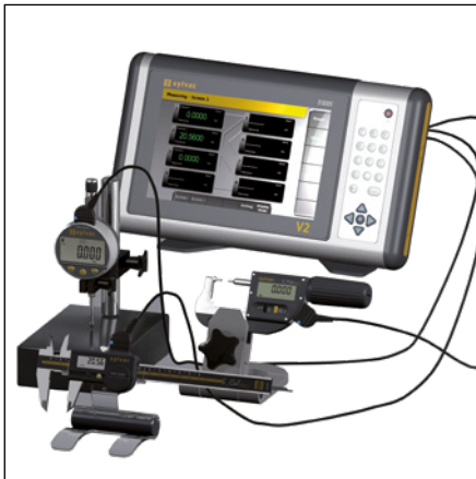
Muchos instrumentos conectados al D300S con valores mostrados coloreados para indicar tolerancias
