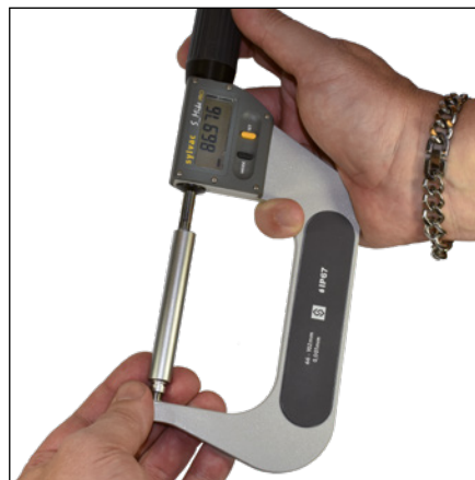
Medición de longitud de pieza torneada
