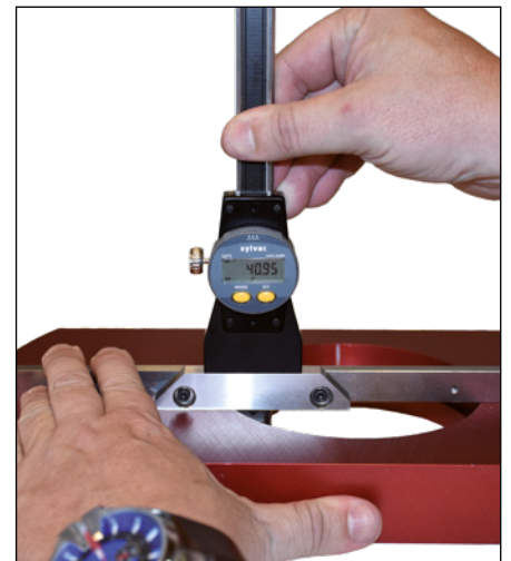
Medición de profundidad en agujero utilizando base adicional
